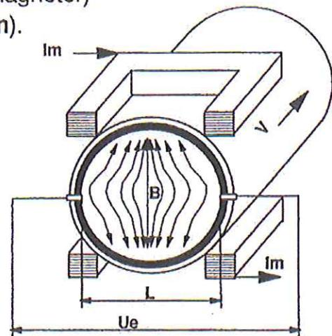
Avstanden mellom elektrodene og styrken på magnetfeltet( $B$ ) er kjente og konstante\*. Strømningshastigheten( $V$ ) vil da bestemme styrken på indusert spenning( $U_e$ ).
